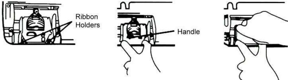
3. Inserire in modo corretto una nuova cartuccia tra la guida del nastro e la testa della stampante. Premere la testa della cartuccia fino a che non si inserisca in posizione. Girare la manopola in senso orario per fissare il nastro.
