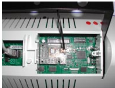
Figura 36: Kit GPS installato
