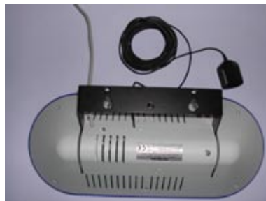
Figura 37: Particolare dell'uscita del cavo antenna GPS
